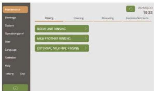
**Proplach spařovací jednotky:** provede okamžitý proplach spařovací jednotky horkou vodou.
