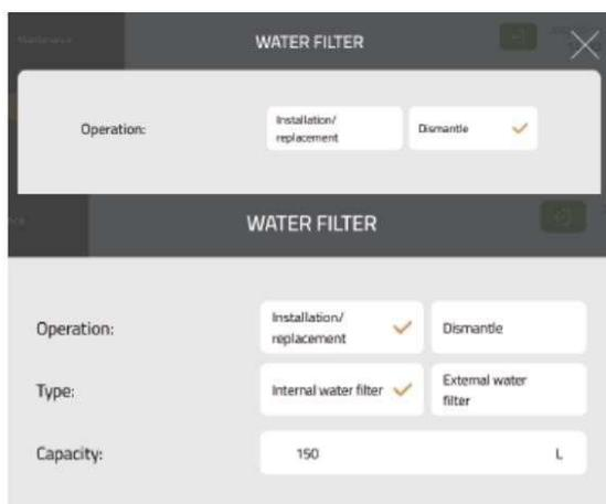
**Připojení a odpojení vodního filtru:** pokud v kávovaru nepoužíváte vodní filtr, zvolte možnost „Žádný filtr“ (Dismantle). V případě, že chcete připojit vodní filtr, zvolte možnost „Instalace / výměna“.
