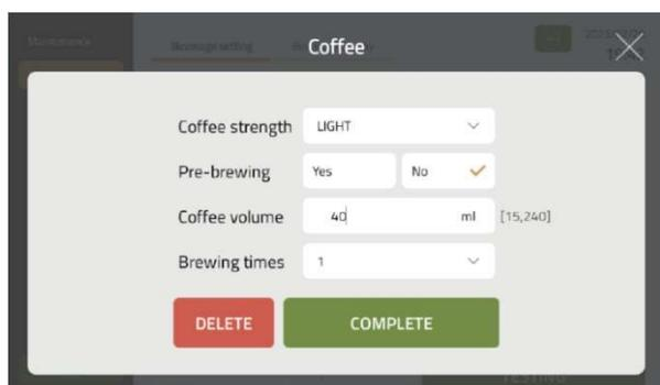
**Úprava jednotlivých kroků receptu:** jednotlivé kroky lze dále upravovat stiskem ikony příslušného kroku. V případě kroku „Káva“ lze například změnit intenzitu, předspaření, objem v ml a extrakční dobu. Úpravu receptů běžnými uživateli je možné omezit či zcela zakázat po přihlášení jako administrátor.
