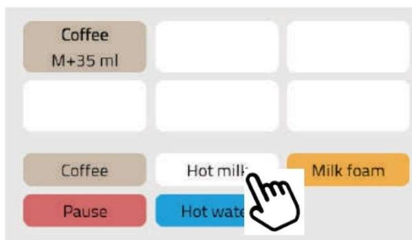
**Tvorba nového nápoje:** Po stisku tlačítka Přidat v menu nastavení nápojů je možné přidávat a upravovat kroky, ze kterých bude nový nápoj složen. Krok lze přidat stiskem jeho ikony na spodní straně obrazovky. Nápoj může být složen až ze 6 kroků. Nastavitelnost jednotlivých kroků je popsána níže v kapitole „Přehled parametrů receptů“.
