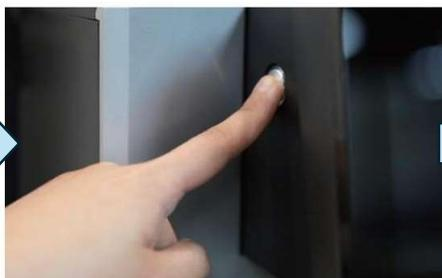
Stiskněte tlačítko Zapnout / Vypnout na levé boční straně obrazovky kávovaru.
