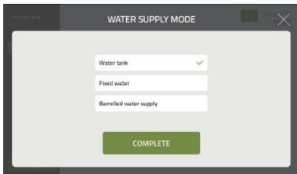
**Zdroj vody:** v tomto nastavení lze volit mezi připojením na vodovodní řád, čepráním vody z barelu a čerpáním vody z integrované vodní nádržky.
