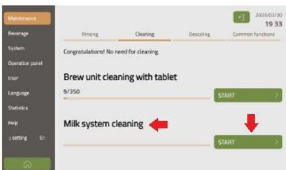
**Čištění mléčného systému:** naplňte příslušnou komoru prostředkem pro čištění mléčného systému kávovaru a stiskněte tlačítko Start. Na obrazovce se zobrazí zpráva o probíhajícím čištění a kávovar spustí čisticí program. Čištění trvá přibližně 10 minut. V průběhu čištění není možné vydávat nápoje.
