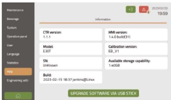
V sekci Nápověda (Help) lze mimo jiné zobrazit podrobné informace o přístroji. To zahrnuje verzi PCB softwaru, verzi HMI softwaru, verzi operačního systému, data o kalibraci nebo výrobní číslo přístroje. Pomocí zeleného tlačítka v dolní straně obrazovky lze taktéž provést aktualizaci softwaru z USB disku. Provádění aktualizací či jiných zásahu do softwaru smí provádět jen kvalifikovaný servisní technik.
