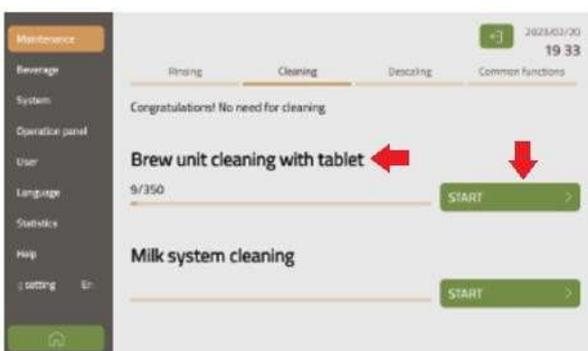
**Čištění spařovací jednotky:** vložte čisticí tabletu do příslušné komory a stiskněte tlačítko Start. Na obrazovce kávovaru se zobrazí zpráva o probíhajícím čištění a kávovar spustí čisticí program. Čištění trvá přibližně 10 minut. V průběhu čištění není možné vydávat nápoje.
