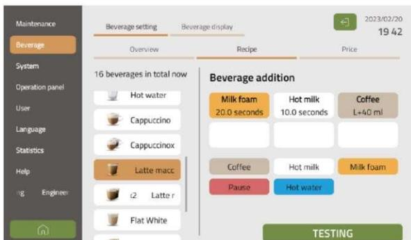
**Kontrola složení receptu:** při otevření konkrétního nápoje se zobrazí jednotlivé kroky, které kávovar provede při jeho výdeji. Pořadí provedení kroků je zprava doleva - recept na obrázku tedy započne výdejem mléčné pěny (Milk foam), pokračuje výdejem horkého mléka (Hot milk) a je zakončen výdejem kávy (Coffee).
