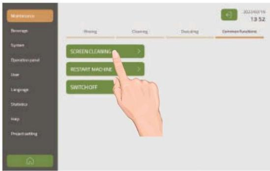
**Čištění obrazovky:** stiskněte tlačítko Čištění obrazovky (Screen cleaning). Obrazovka přestane reagovat na dotyk po dobu 15 vteřin. Nyní lze displej bezpečně očistit. K čištění používejte výhradně suchou, jemnou látku bez čisticího prostředku.
