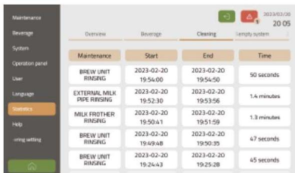
Při zobrazení historie čištění lze přesně sledovat čas zahájení, průběhu a dokončení čistících úkonů.
