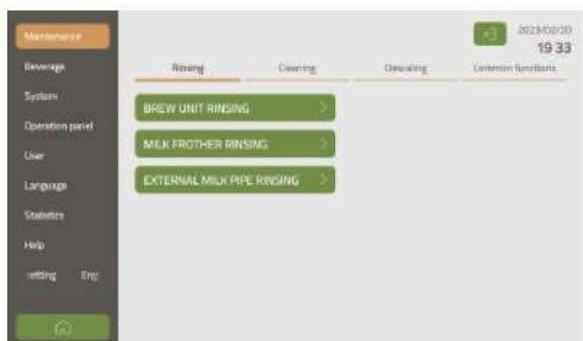
Denní čištění / proplach provádí kávovar automaticky dle nastavení parametrů údržby. Práva k provádění čistících úkonů určuje administrátor v příslušném nastavení.
